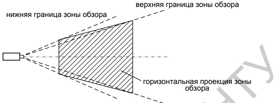
Рисунок 1.5 – Проекции зоны обзора на горизонтальную плоскость
