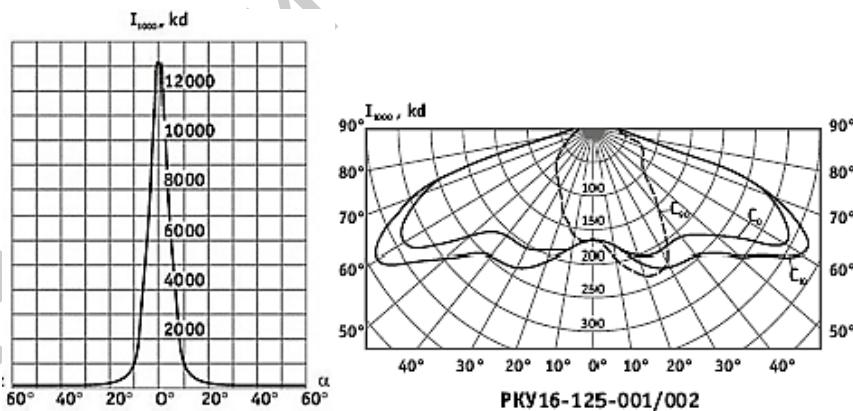
Рисунок 2.4 – Кривые силы света осветителя
