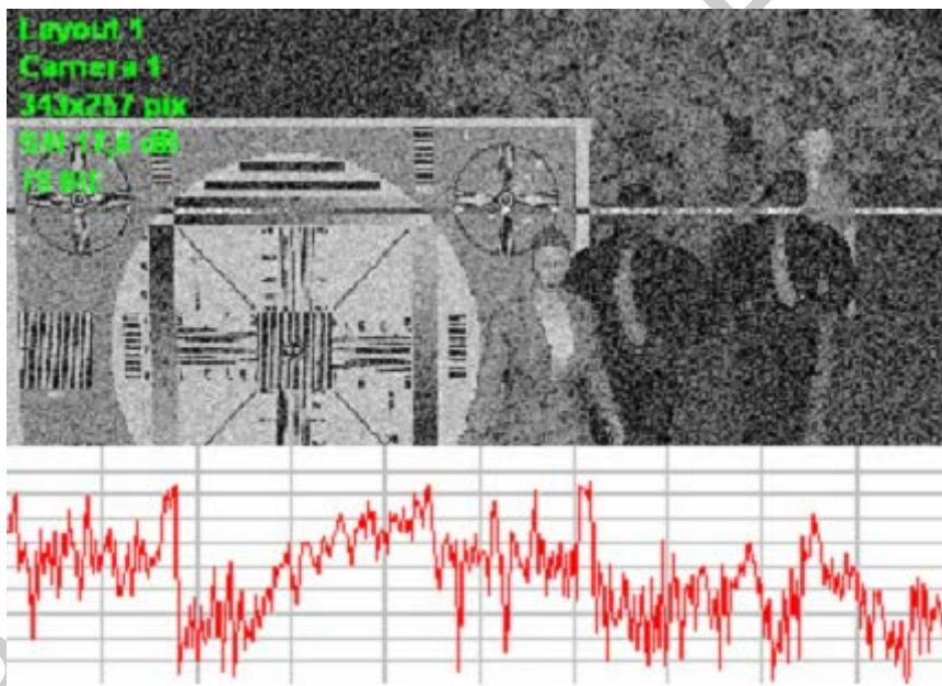
Рисунок 2.12 – Чувствительность камеры 0,1 лк при 80 IRE и сигнал/шум 17 дБ.
