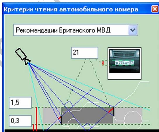
Рисунок 1.1 – Изображение на экране монитора зоны обзора
