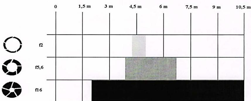
Рисунок 1.4 – Формирование зоны обзора видеокамеры с учетом глубины резкости:
