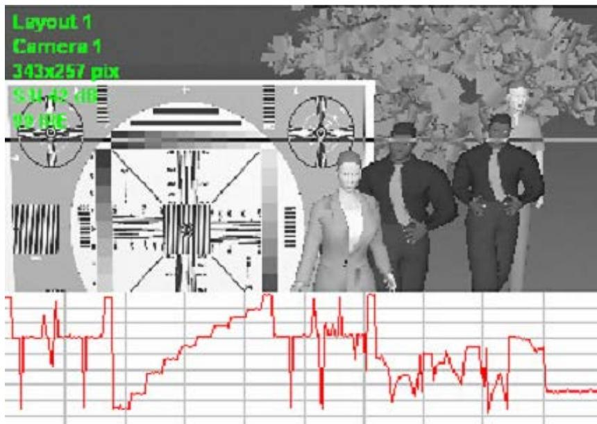
Рисунок 2.8 – Изображение и видеосигнал при высокой освещенности сцены
