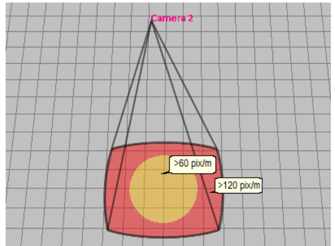
Рис. 17,18. Поле зрения камеры. С подушкообразной дисторсией поле зрения напоминает бочку. Пространственное разрешение от центра к краям поля зрения увеличивается.
